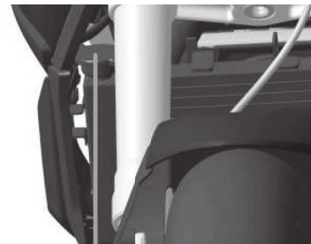
Boca de relleno
